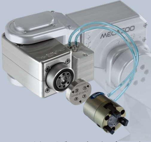
MPM500 と空気圧式グリッパー（オプション）の取り付け例
